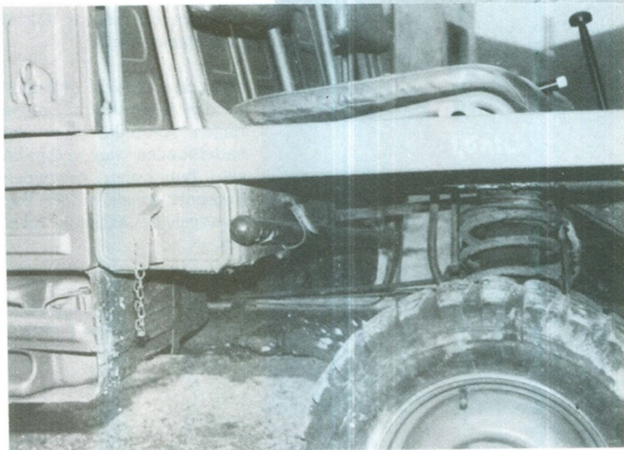
Een blik op de positie boven het rechter voorwiel, met de bergplaats voor een jerrycan, een opbergvak, de schop en de schroefveer van het rechter voorwiel.
